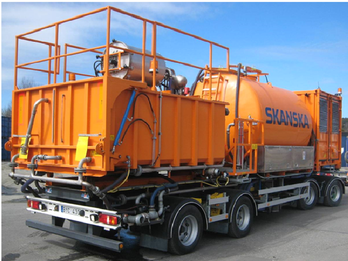
Figur 5.33. Skanskas egenutvecklade rengöringsutrustning, VÄGREN.
