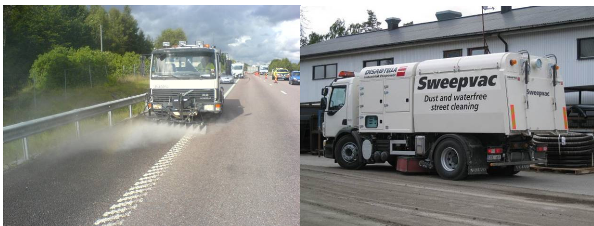
Figur 4.2. Exempel på separat spol- och sugfordon (Stivab, Disab-Tella AB).
