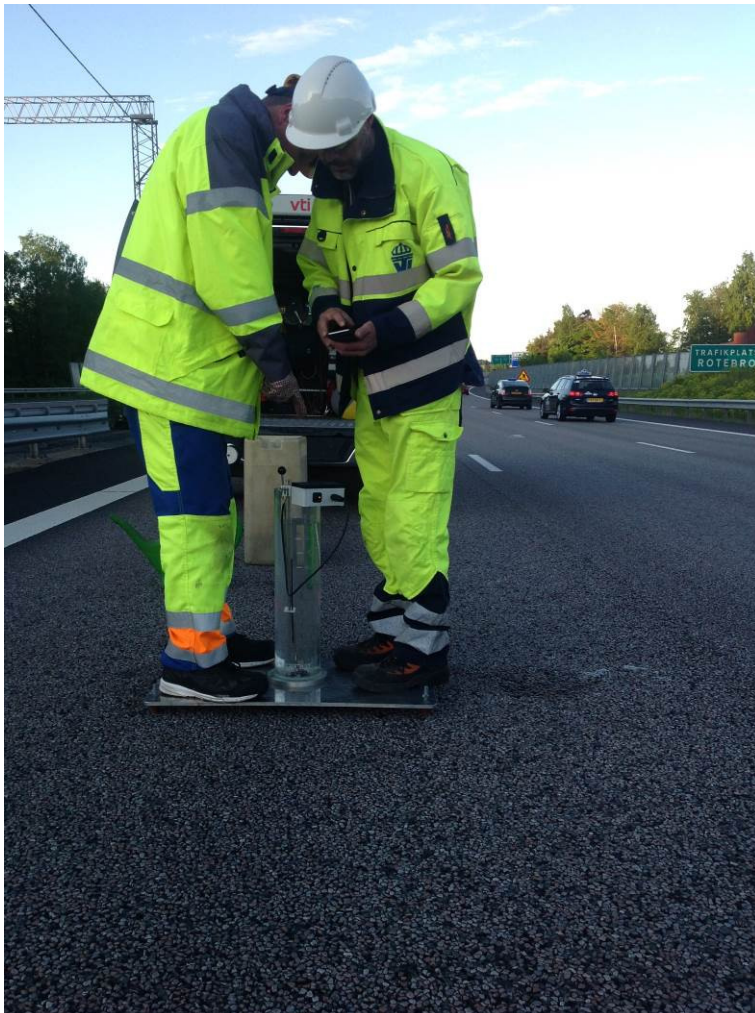
Figur 3.3. Permeabilitetsmätning med VTI-utrustning.
