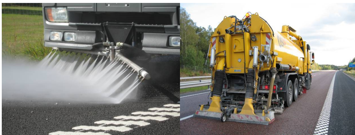
Figur 4.5. Norsk högtrycksutrustning (Oslo Lufthavn – OSL).
