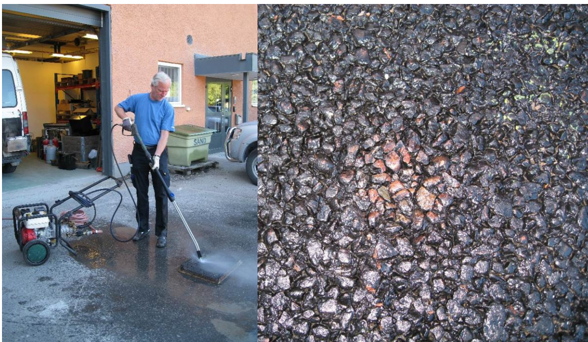
Figur 5.2 Extrema tester med högt tryck och hetvatten vid VTC-Nord i Farsta.
