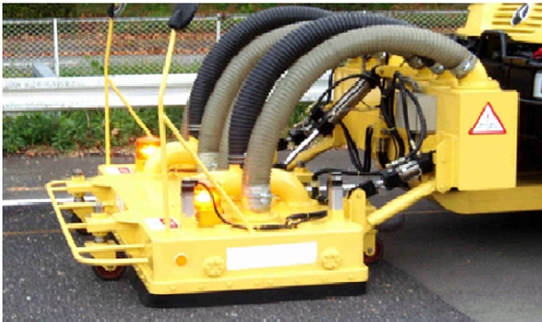
Figur 4.9. Japansk specialhögtrycksutrustning (endast tryckluftsrening).
