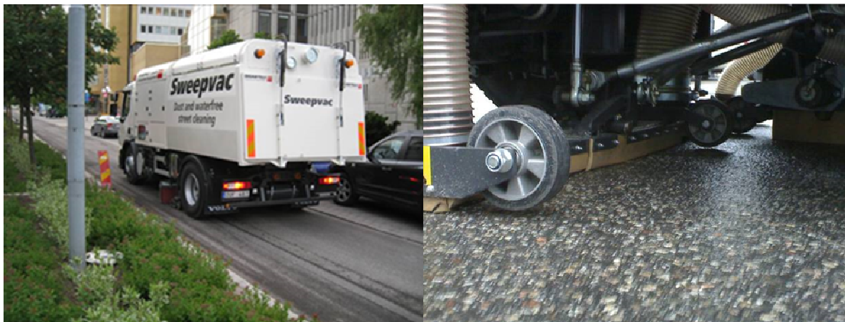
Figur 4.4. Rengöring av fräslåda samt ledat sugmunstrycke (Disab-Tella AB)
