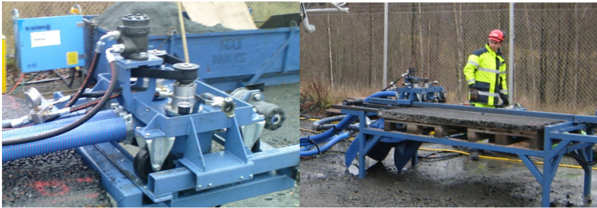
Figur 5.15. Egenutvecklad rengöringsramp samt testrigg för spoltester.
