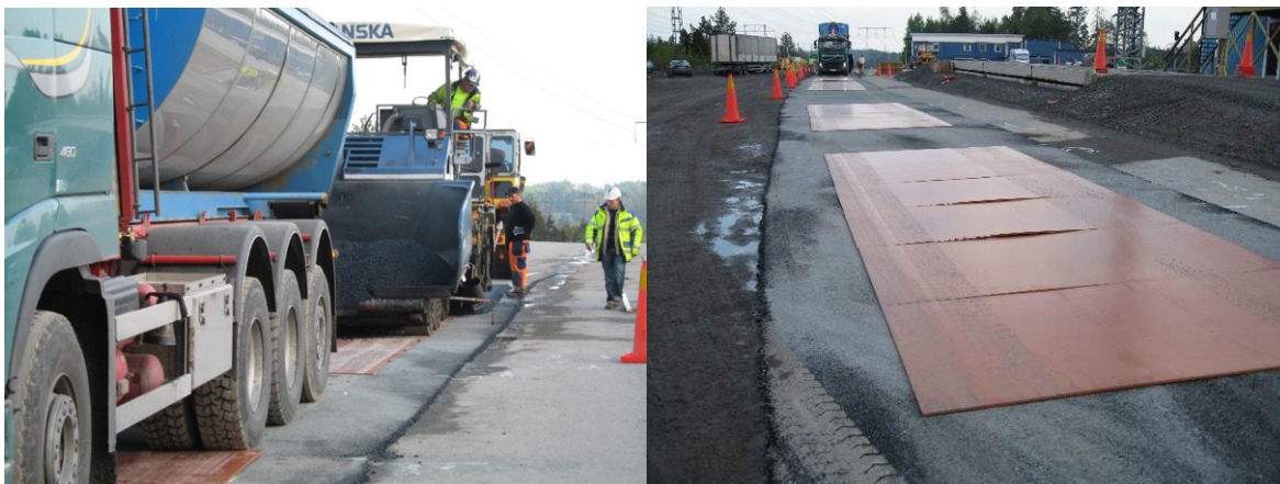
Figur 5.1 Tillverkning av provplattor vid Skanskas asfaltverk i Vällsta.
