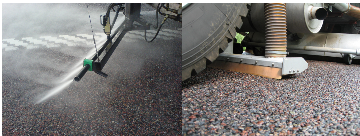
Figur 4.3. Frontmonterad spolramp samt sugaggregat (Stivab, Disab-Tella AB).
