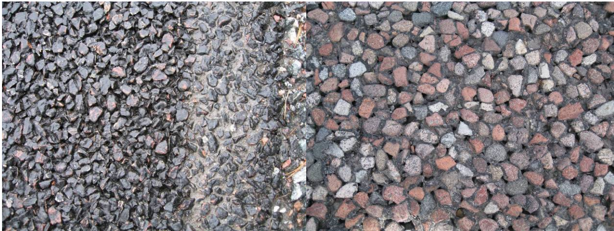
Figur 4.13. Visuell effekt av högtryckstvättning.
